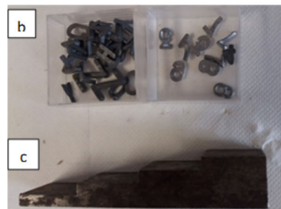
Figura 6. (a) Juego de índices de calidad. (b) Letras y números de plomo. (c) Índices de calidad de escalerilla.
