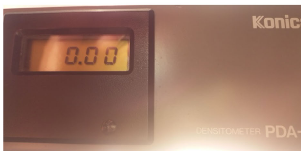
Figura 12. Puesta a cero o calibración del densitómetro.
