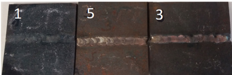
Figura 8. Uniones soldadas sobre chapas de fundición nodular.
